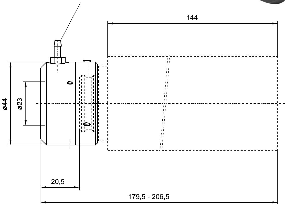
Blasluft Öl-, Wasser- und Staubfrei / dry, clean air ( oil and dust- free )
