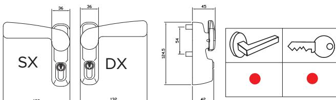
Dispositivo externo de apertura para ser utilizado en combinación con los manillones de sobreponer ISEO.
