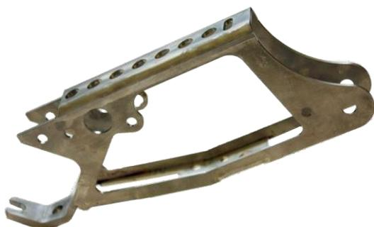
Verificare la presenza di danni e sostituire in caso di bruciatura, deformazione pronunciata, deterioramento del meccanismo di ribaltamento o supporti piegati. Affinare con cura le flange dei bulloni di supporto. Pulire il punto di contatto del supporto con una spazzola metallica. La levigatura è vietata!
