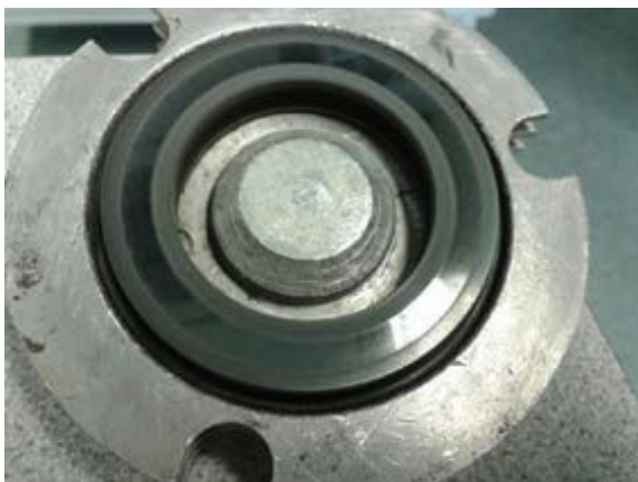
CVD diamantbelagt tætningsoverflade, som set efter 10 timers tørkørsel ved 1500 rpm.
