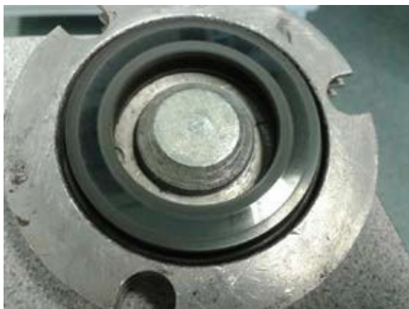
Superficie de sellado recubierta de diamante CVD, tal como aparece después de 10 horas de funcionamiento en seco a 1500 rpm.
