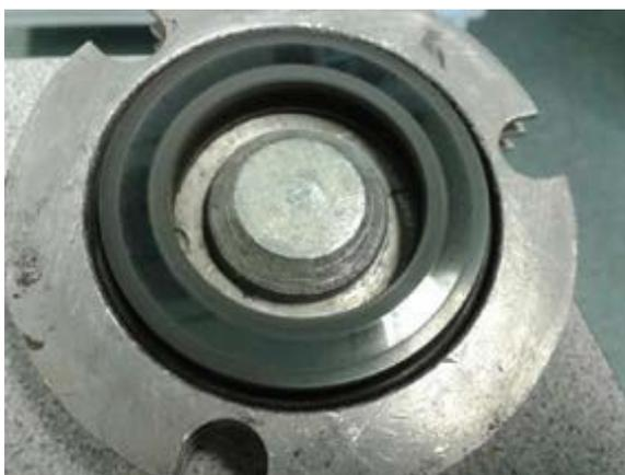
Superficie di tenuta rivestita con diamante CVD, come appare dopo 10 ore di funzionamento a secco a 1500 giri / min.
