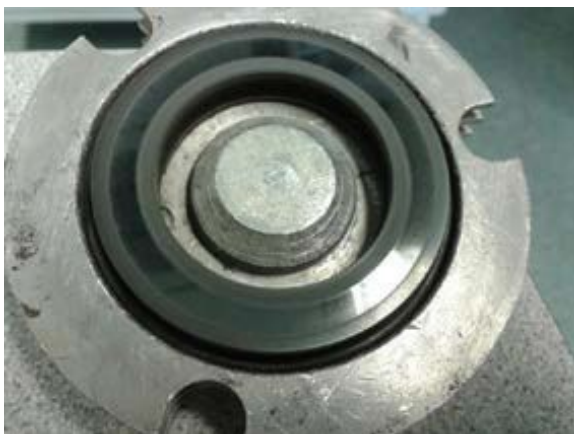
CVD-diamantgecoat afdichtingsoppervlak, zoals te zien na 10 uur droogdraaien bij 1500 tpm.
