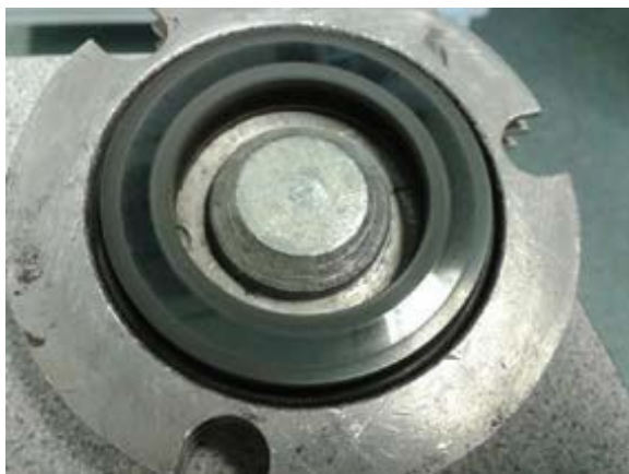
Powierzchnia uszczelniająca pokryta diamentem CVD, jak wygląda po 10 godzinach pracy na sucho przy 1500 obr./min.
