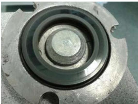
Superfície de vedação revestida com diamante CVD, conforme visto após 10 horas de funcionamento a seco a 1500 rpm.
