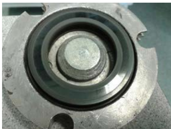
Уплотнительная поверхность с алмазным покрытием CVD, вид после 10 часов работы всухую при 1500 об/мин.
