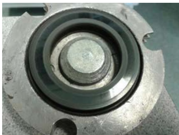
CVD diamantbelagd tätningssyta, sedd efter 10 timmars torrkörning vid 1500 rpm.
