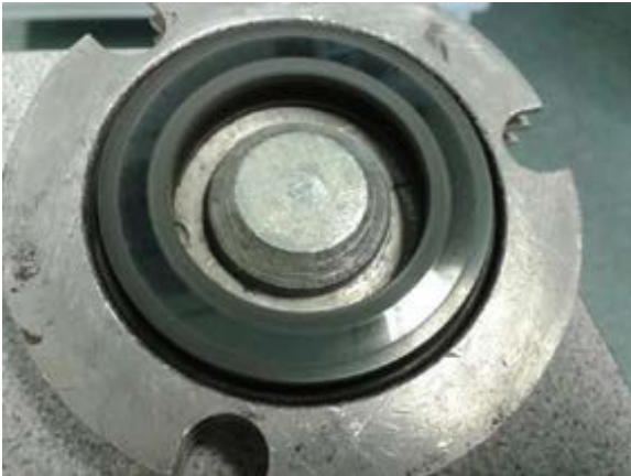
1500 rpm'de 10 saat kuru çalışma sonrasında görülen CVD elmas kaplamalı sızdırmazlık yüzeyi.
